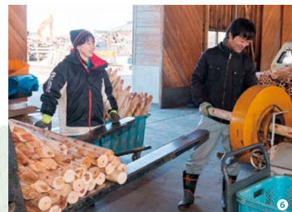
④組合敷地内にある小径木加工施設。平成10年に立ち上げた ⑤県内でも数社しかない木材防腐ラインを完備。防腐処理の依頼も多い ⑥右は円柱棒の片側を先研ぎしているところ。工事現場用の土木資材や公園の柵の支柱となる杭に使用される
