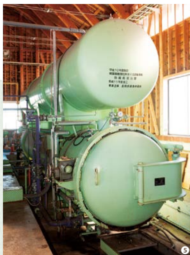
④組合敷地内にある小径木加工施設。平成10年に立ち上げた ⑤県内でも数社しかない木材防腐ラインを完備。防腐処理の依頼も多い ⑥右は円柱棒の片側を先研ぎしているところ。工事現場用の土木資材や公園の柵の支柱となる杭に使用される
